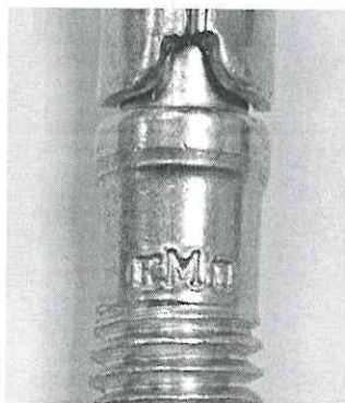
Рис. 3. Маркировка на шпильке
